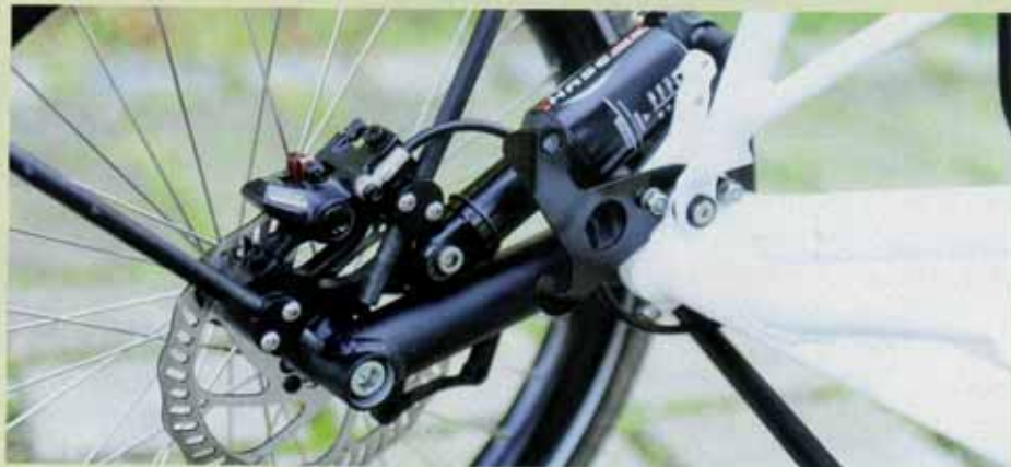
Die neue Federung bringt 80 Millimeter komfortablen Federweg.
