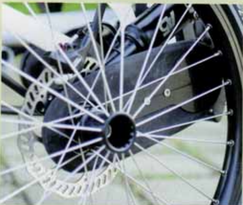
Der geschlossene Kettenkasten am Hinterbau
