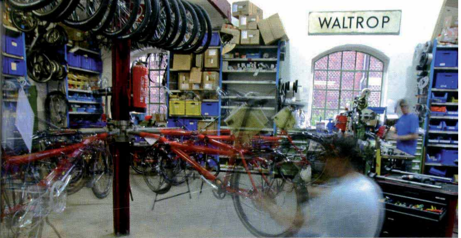
Eines von mehreren Montage-Karussells in der Werkhalle: An den Auslegern hängen die vorgefertigten Rahmen. Die Räder werden in sorgfältiger Handarbeit zusammengebaut.
