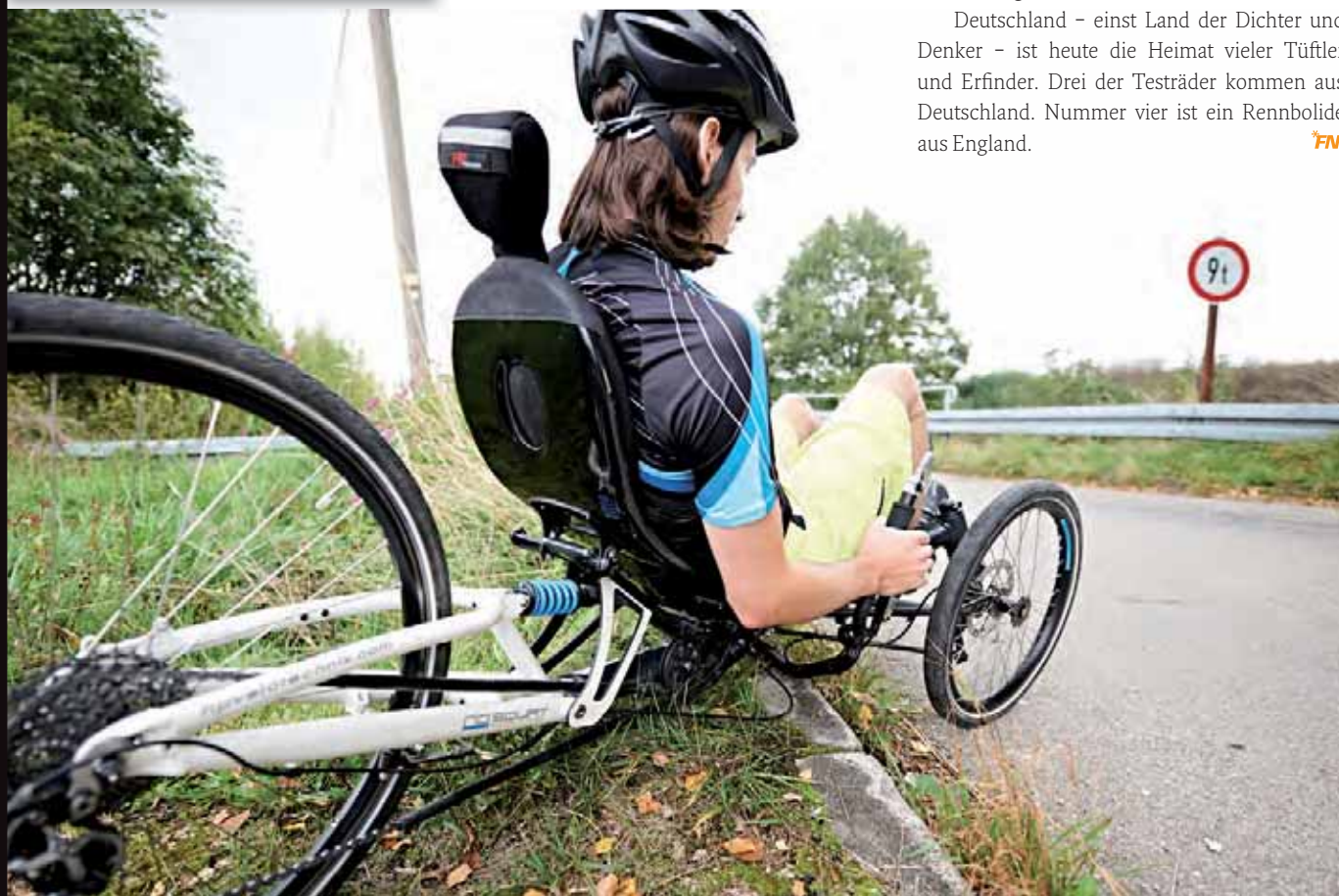
Scorpion f s 26: Zwölf Zentimeter Bodenfreiheit und Federelemente fesseln einen nicht an die Straße.
