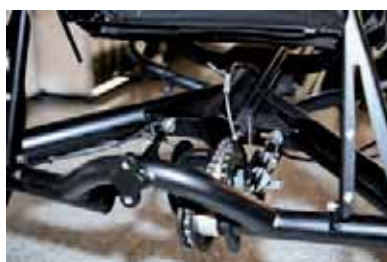
Ohne Differenzial konzentriert sich die komplette Antriebskraft auf das rechte Hinterrad.
