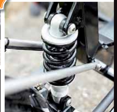
Mithilfe von zwei Schnellspannern kann der Vorderbau ein- oder ausgefahren werden (oben). Für den nötigen Sitzkomfort sorgt ein Federelement unterm Sitz (rechts).
