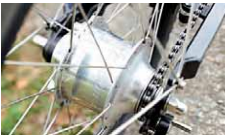
So viel Technik in dieser kleinen Dose! Pflege war gestern – die Rohloff Speedhub macht einem auf langen Touren das Leben leicht.
