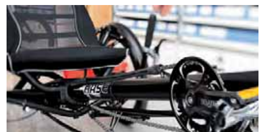
Mit zwei Schnellspannern lässt sich das Rahmenrohr rasch anpassen. Der Umlenkmechanismus verhindert, dass die Kette am Boden schleift.
