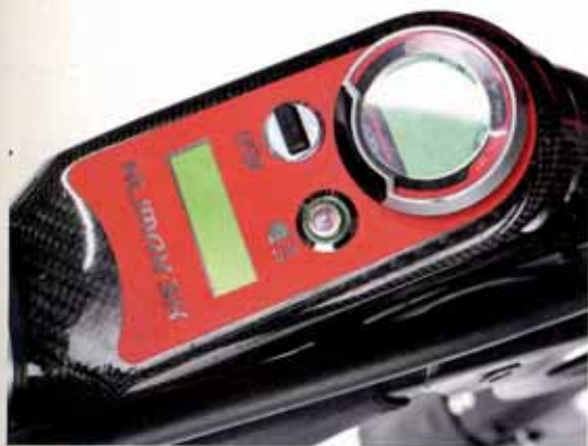
Armaturenbrett: mit Trelock Tacho, Licht ein/aus, USB-Port und Display (Modi, Batterieanzeige).
