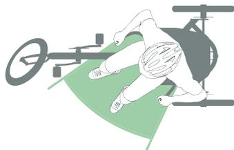
> À l'arrêt, la stabilité d'un trike delta permet une installation en tout confort sur le siège entre les deux roues arrière.
