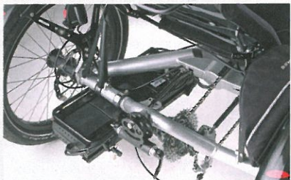
Bedienelement am Lenkerende: Ladezustand in Grün, Gelb, Rot. Turbo-Hebel für Kraftzugabe via Daumendruck Ausbaubarer Akku – nahe am Boden. Einschalt-Schlüssel sitzt unpraktisch tief.
