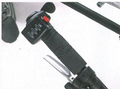
Bedienelement am Lenkerende: Ladezustand in Grün, Gelb, Rot. Turbo-Hebel für Kraftzugabe via Daumendruck Ausbaubarer Akku – nahe am Boden. Einschalt-Schlüssel sitzt unpraktisch tief.
